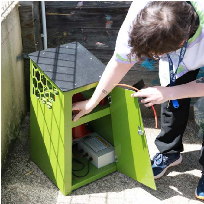
> Priscilla, agent de la crèche Neptune, procédant au nettoyage du filtre de la borne anti-moustiques.
